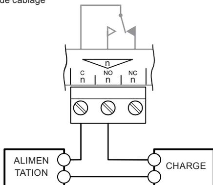
Les contacts du relais sont fermés (c.-à-d. NO passe par C) lorsque le canal de sortie est sur ON.
