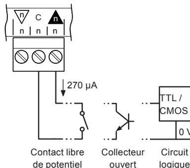
Le contact libre de potentiel a un courant de mouillage nominal de 270 μA. L'entrée est sous tension (sur ON) lorsque le contact est fermé.
