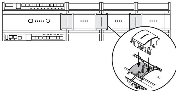
*Remarque : les interconnecteurs rigides ne peuvent pas être utilisés entre des modules IQ4/IO et des modules XCITE/IO ou un contrôleur IQ3/XCITE. Le cas échéant, une interconnexion câblée doit être utilisée (voir ci-après).*
