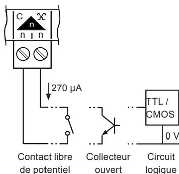
Le contact libre de potentiel a un courant de mouillage nominal de 270 μA. L'entrée est sous tension (sur ON) lorsque le contact est fermé.
