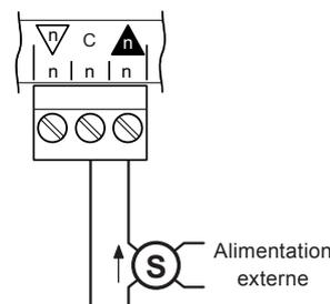
En mode alimentation en boucle, le terminal de sortie  $\nabla$  peut fournir 20 Vdc maximum pour alimenter le capteur.
