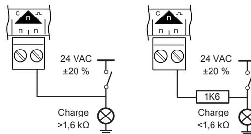
Dans l'exemple ci-dessus, l'entrée est sous tension (sur ON) lorsque la charge est alimentée. Si l'impédance de charge est inférieure à 1,6 kΩ (par ex. une lampe à filament ou une bobine de relais), une résistance de 1,6 kΩ doit être installée en série avec l'entrée.
