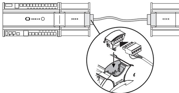
*Remarque : L'adaptateur de câble IQ4/IC/ADPT inclut des fusibles et diodes de suppression de surtension transitoire non remplaçables qui protègent le bus d'E/S des surintensités et surtensions causées par des conditions électriques transitoires ou un câblage incorrect.*
