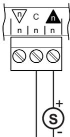
**Entrée digitale** : Utilisée pour un contact libre de potentiel, un circuit logique (par ex. TTL, CMOS), un collecteur ouvert (transistor) ou drain ouvert (FET).
