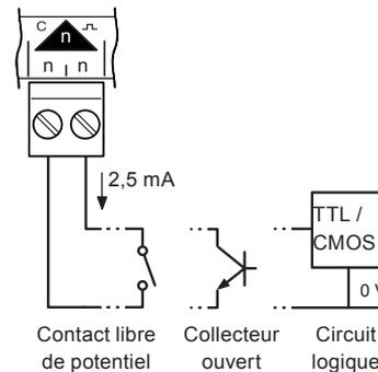
Le contact libre de potentiel a un courant de mouillage nominal de 2,5 mA. L'entrée est sous tension (sur ON) lorsque le contact est fermé.
