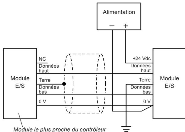
**Important :** la connexion 0 V doit être appliquée lorsqu'une alimentation externe est utilisée et que la ligne 0 V doit être continue sur toute la longueur du bus E/S.
