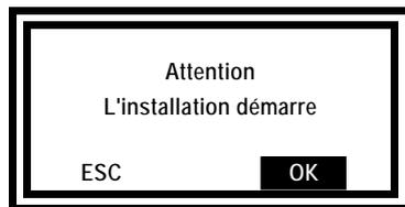
2. Confirmer en appuyant sur bouton navigateur "OK". Le régulateur commence à fonctionner avec les réglages effectués; l'installation démarre et le menu principal s'affiche :
